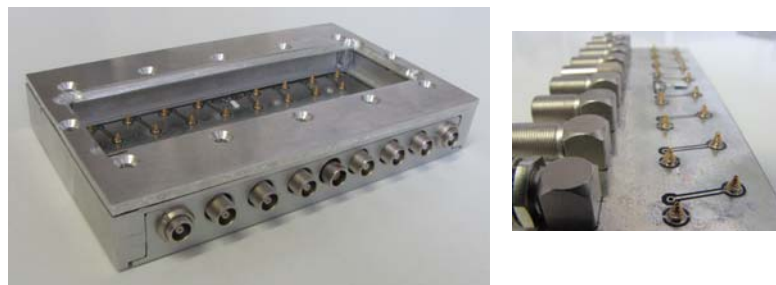
Abb. 3: Messzellegehäuse für den 16-kanaligen Sensor (links) sowie vergrößerte Ansicht einer Platine zur Kontaktierung von 8 Wandlern (rechts).
